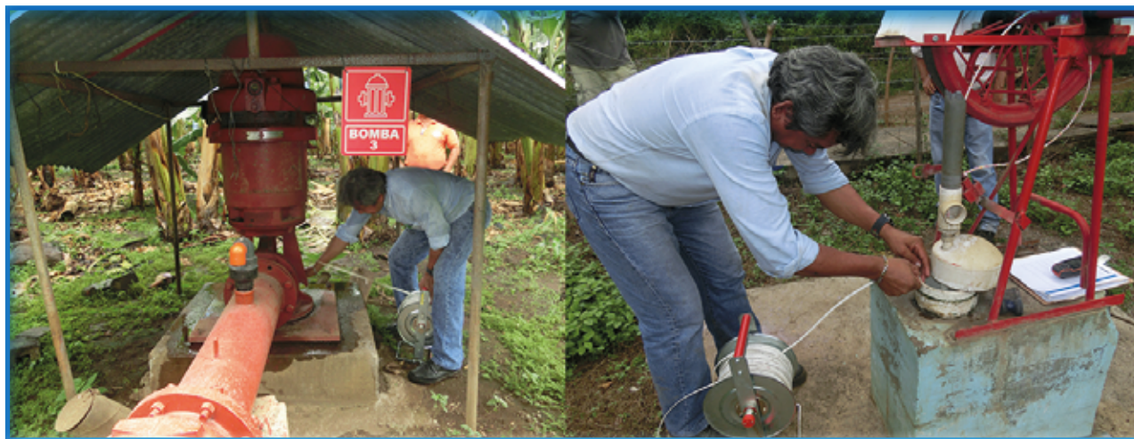
Foto 16. Izquierda. Medición del nivel de agua subterránea de pozo explotado por finca bananera en El Viejo. Foto 17. Derecha. Medición de nivel de agua subterránea de pozo utilizado para abastecimiento comunitario en El Viejo.
