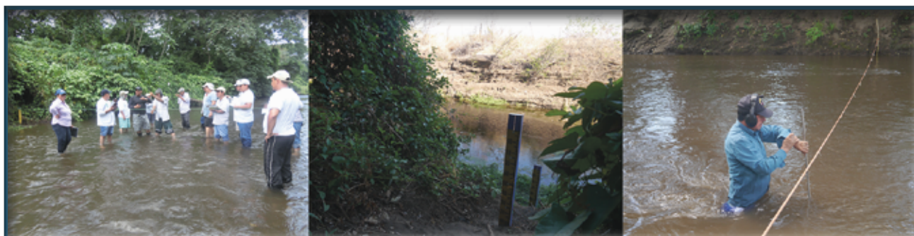
Foto 11. Izquierda. Capacitación de técnicos municipales en aforos, río Posoltega julio 2016. Foto 12. Centro. Limnímetros ubicados por INETER en río Tamarindo, León. Foto 13. Derecha. Medición de caudales en río Posoltega, INETER noviembre 2016.
