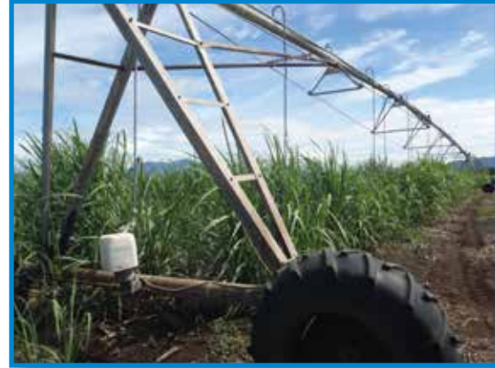
Foto 47. Sistema de riego automecanizado. Pivote central de aproximadamente 400 m, abastecido a través de un pozo. Finca ubicada en Quezalguaque.
