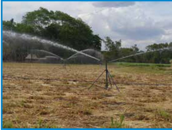
Foto 46. Sistema de riego semifijo por aspersión, abastecido por agua subterránea, finca ubicada en León.
