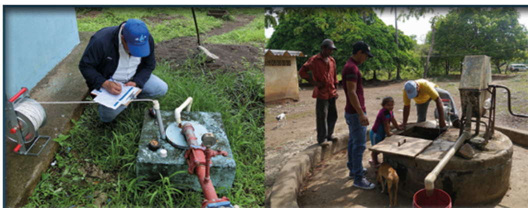
Foto 14. Izquierda. Medición del nivel de agua subterránea de pozo ENACAL. Foto 15. Derecha. Medición del nivel de agua subterránea de pozo comunitario del municipio de León.
